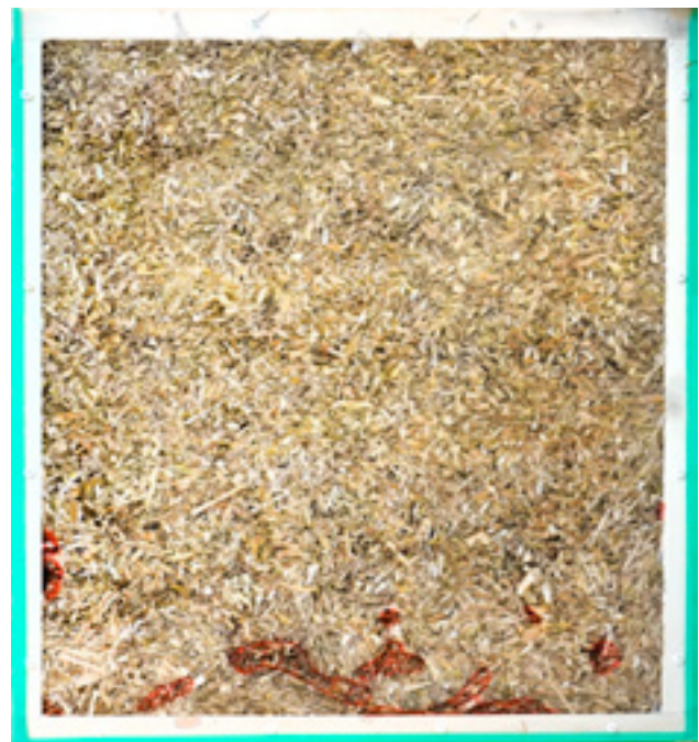
Isolatie van lisdodde. Bron: Bouwgroep Dijkstra Draisma
